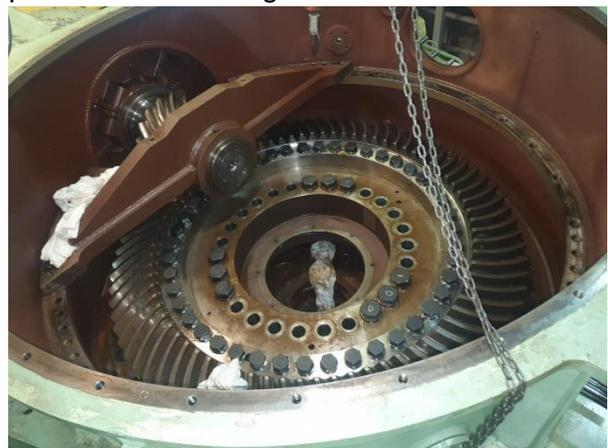
Abbildung 2: Im Inneren des Geräteraumes – Hier: Das zu wartende Getriebe des Voith Schneider Propellers.
