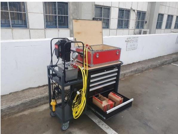
Abbildung 3: Der Servicewagen wurde von unserem Vertriebspartner dem Kunden bereitgestellt. Auf ihm steht der AT 20 und die Veloxpumpe mit den AHDS 5m Schläuchen. In der Schublade befinden sich die Stacos.
