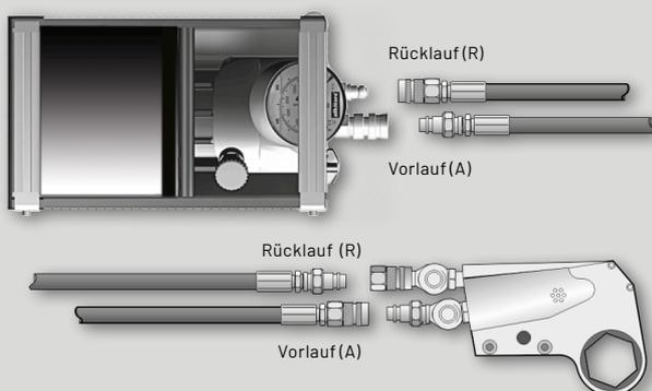
Im Lieferumfang: Hydraulikschläuche, Länge 5m (DN 8)
