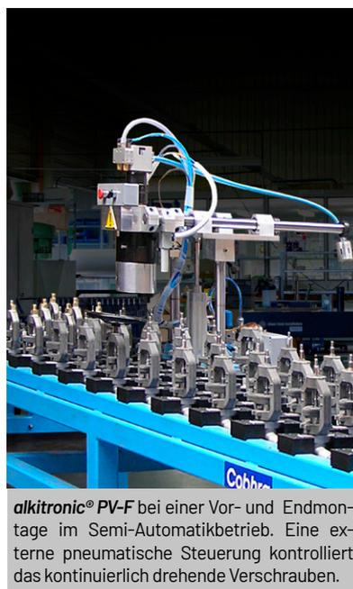
**alkitronic® PV-F** bei einer Vor- und Endmontage im Semi-Automatikbetrieb. Eine externe pneumatische Steuerung kontrolliert das kontinuierlich drehende Verschrauben.
